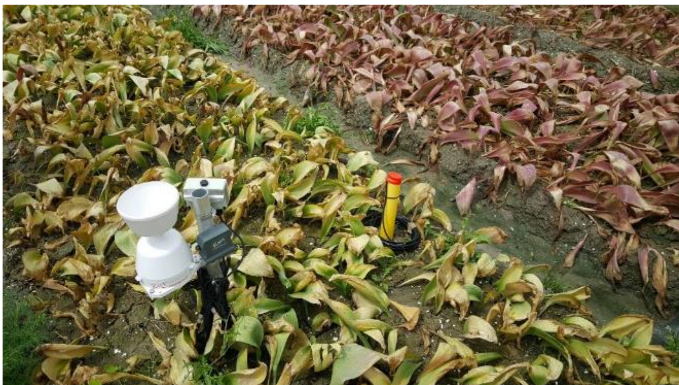
Afbeelding 2: Meetopstelling. De gele buis is het grondwaterstandsmeetpunt.
