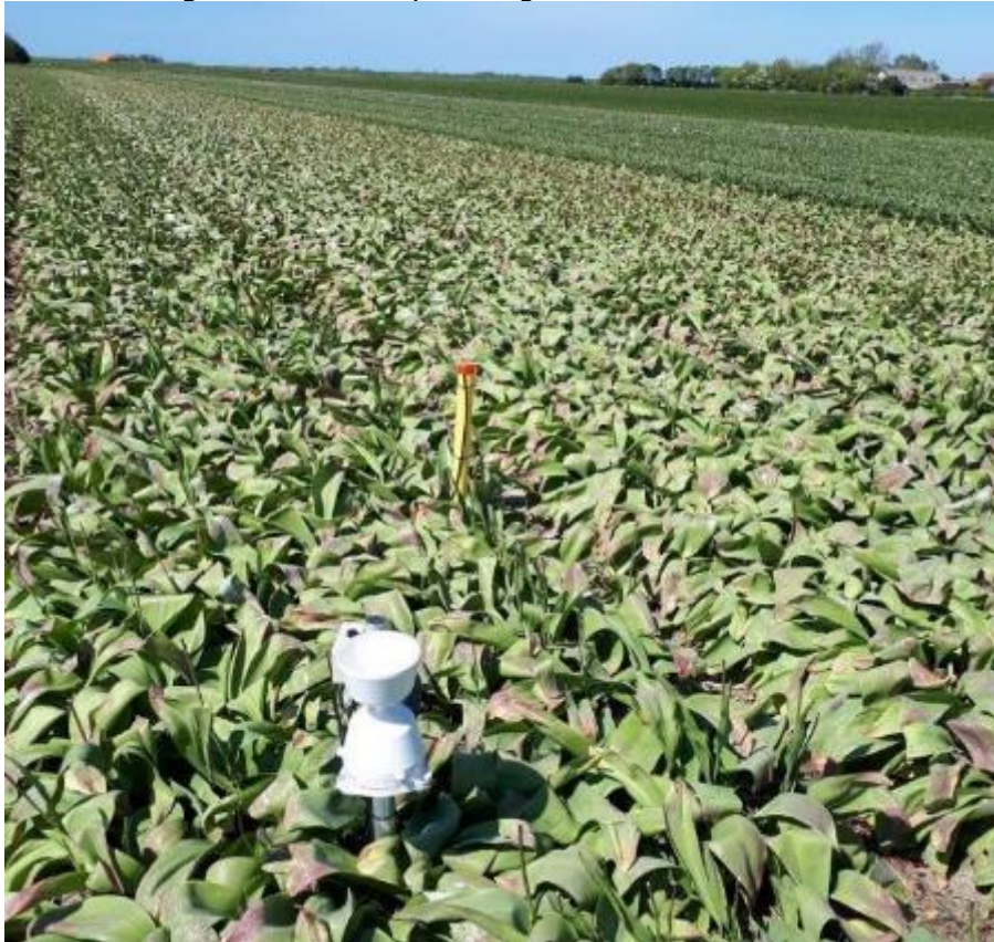
Afbeelding 2: Meetopstelling. De gele buis is het grondwaterstandsmmeetpunt.
