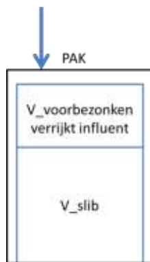
Figuur 2: schematische weergave van het batch reactor systeem. V_{\text{voorbezonden verrijkt influent}} = 1\text{ L} , V_{\text{slib}} = 2.8\text{ L} , V_{\text{effluent totaal}} = 3.8\text{ L}
