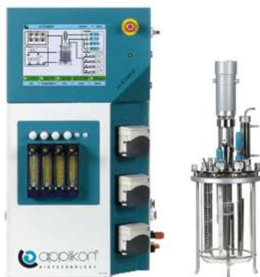
Figuur 2-1: Applikon EZ controller. De aansturing van beluchting, roersnelheid, instellen van opgeloste zuurstof concentratie, T en pH, vindt plaats middels de kast (links). De bioreactor is het glazen gedeelte (rechts). De sensoren zijn geplaatst in de reactoren.
