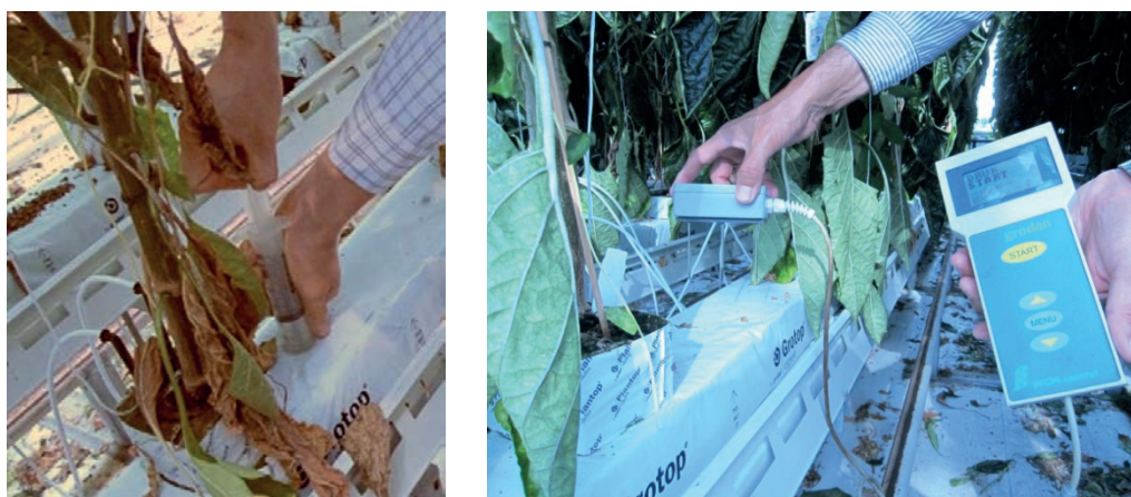
Figuur 10 Monsternamen van water uit de mat (links) en meting van vochtgehalte, EC en temperatuur (rechts).
