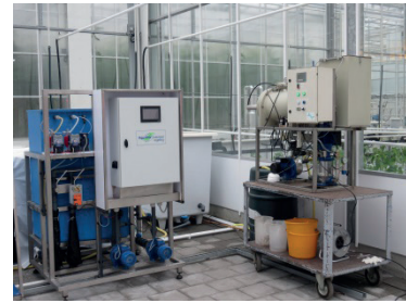
Figuur 3 Techniek voor waterbehandeling in demonstratieruimte (v.l.n.r. vlakbedfilter, substraatunit, ozon-ontsmetting, substraatunit en microfilter).
